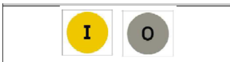
Figura 9 - Indicator pentru poziția separatorului de legare la pământ în celula de linie
