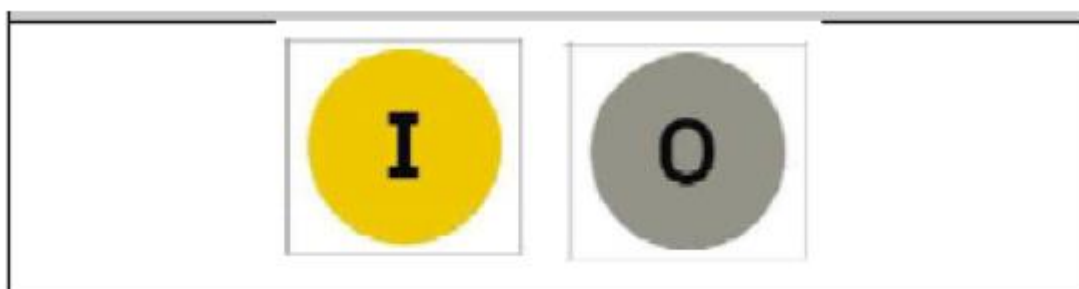
Figura 18 - Indicator pentru poziția separatorului de legare la pământ în celula de linie
