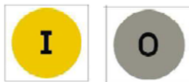
Figura 17 – Indicator pentru poziția separatorului de legare la pământ în celula de linie
