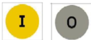
Figura 25 - Indicator pentru poziția separatorului de legare la pământ în celula TRAFO
