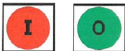
Figura 4 – Indicator pentru poziția întrerupătorului
