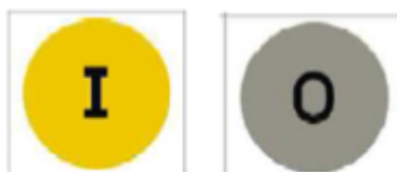
Figura 8 – Indicator pentru poziția separatorului de legare la pământ
