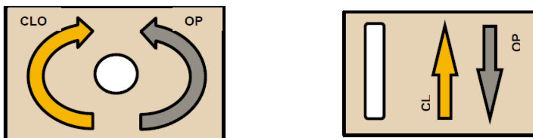
Figura 24 - Locaș pentru funcționarea separatorului de legare la pământ în celula transformator
