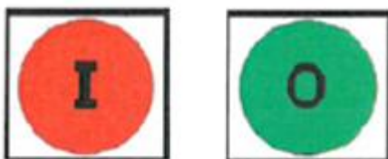
Figura 6 – Indicator pentru poziția separatorului de bare
