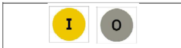
Figura 22- Indicator pentru poziția separatorului de legare la pământ în celula de linie
