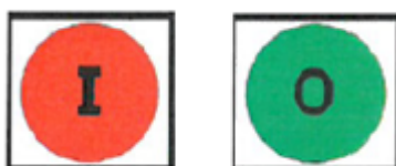
Figura 6 – Indicator pentru poziția separatorului de bare
