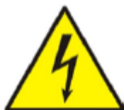
Figura 57 – Pericol de electrocutare
