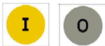
Figura 25 - Indicator pentru poziția separatorului de legare la pământ în celula TRAFO
