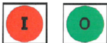
Figura 15 - Indicator pentru poziția IMS în celula de linie
