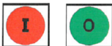
Figura 4 – Indicator pentru poziția întrerupătorului
