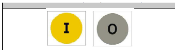
Figura 12- Indicator pentru poziția separatorului de legare la pământ în celula de linie
